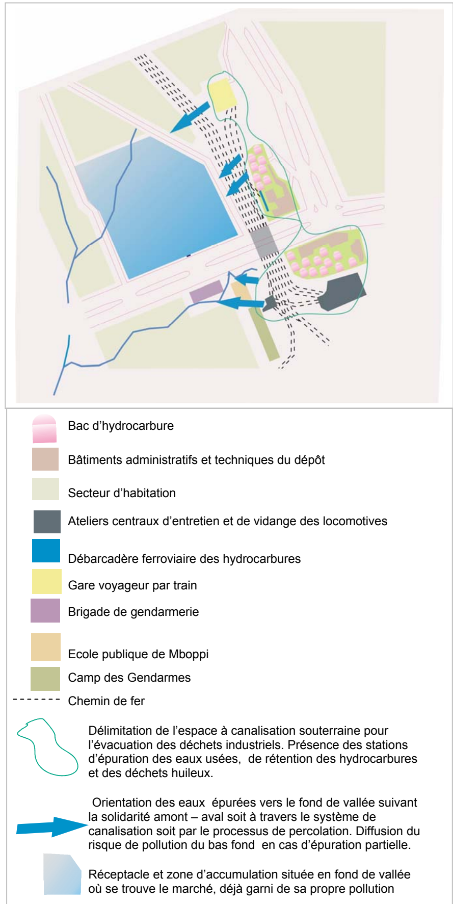
FIGURE 5 : Mise en évidence du risque de pollution du marché lié à la localisation de deux exploitations industrielles en amont
