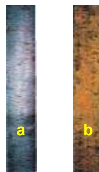
Photo 1 : Découpage d'échantillon de conduite en fer lors de sa substitution (a) façade externe ; (b) façade interne Clichet : Tendron G. 2001
